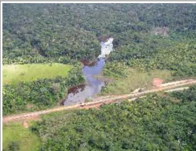
**Figura 18:** Nítido barramento causado pela rodovia
