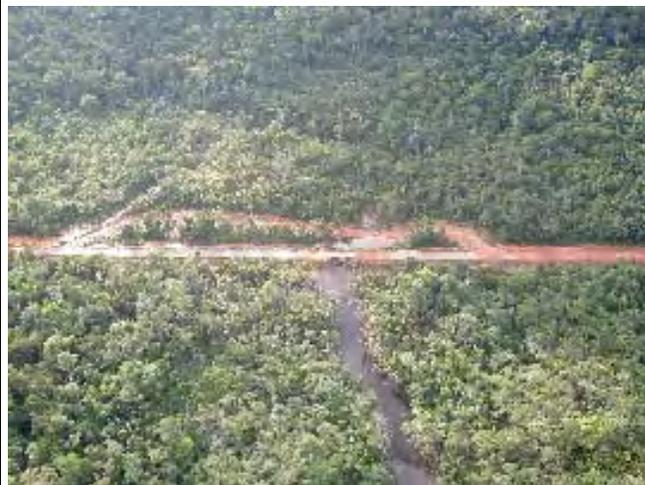
**Figura 33:** Desvio com supressão de Área de Preservação Permanente como preparação para construção de bueiro
