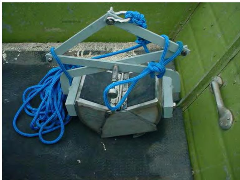
**Foto 1:** Draga de Petersen, utilizada para coleta da macrofauna bentônica nos diferentes ambientes aquáticos amostrados.
