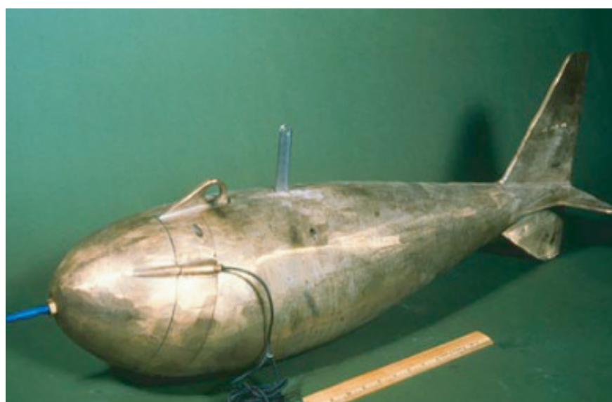
Figura 7.4 - Amostrador pontual integrador US P-63 (DAVIS, 2005)
