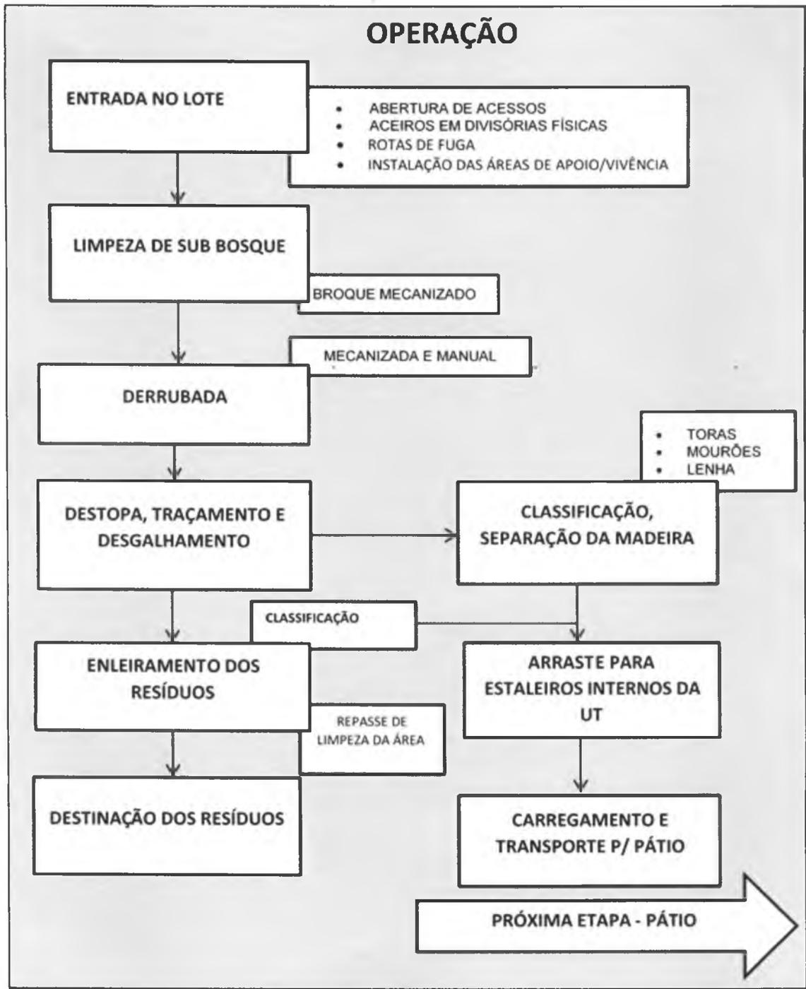
Figura 3 - Fluxo do Desenvolvimento da Operação de Supressão Vegetal
