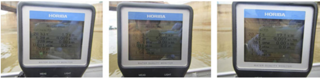
Figura 4. Medidas por Politec (Perícia Oficial e Identificação Técnica) indicando teores de 0,13, 1,32 e 1,56 mg de oxigênio dissolvido por litro na água saindo da barragem em 06 de fevereiro de 2019.
