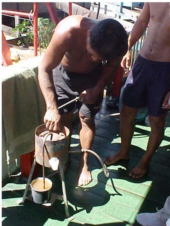
Figura 7. Etapa de separação do Hg do ouro por aquecimento na retorta. *Fonte: Laboratório de Biogeoquímica Ambiental (2003).*
