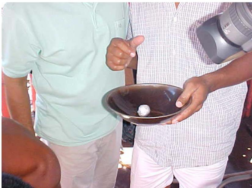
Figura 6. Amálgama Hg-Au na bateia após o processo de captura do ouro fino pronto para a queima. *Fonte: Laboratório de Biogeoquímica Ambiental (2003).*
