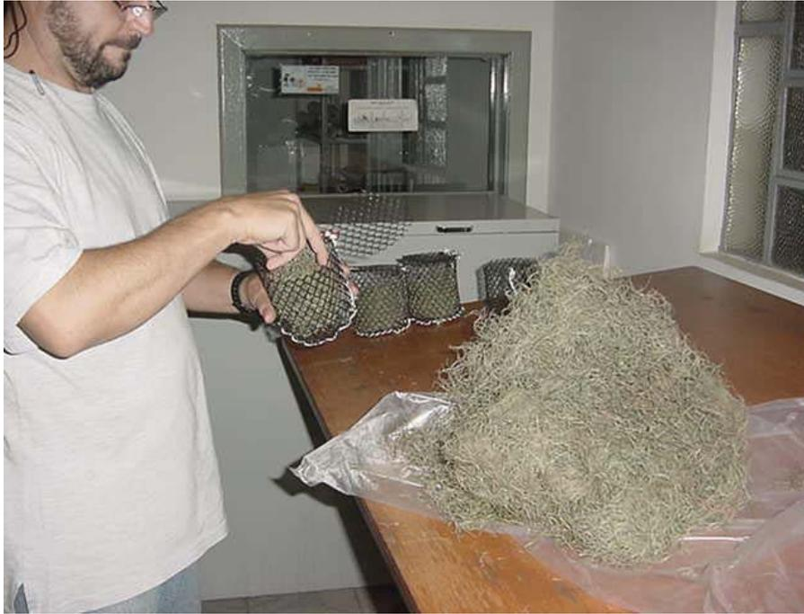
Figura 18. Alíquotas do biomonitor *Tillandsia usneioides* sendo colocadas nas cestas de polietileno para posterior exposição nas lojas de comercialização de ouro. *Fonte: Laboratório de Biogeoquímica Ambiental (2002).*
