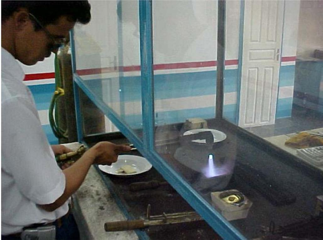
Figura 34. Procedimento de rotina da purificação do ouro dentro da capela no momento da comercialização do metal.
