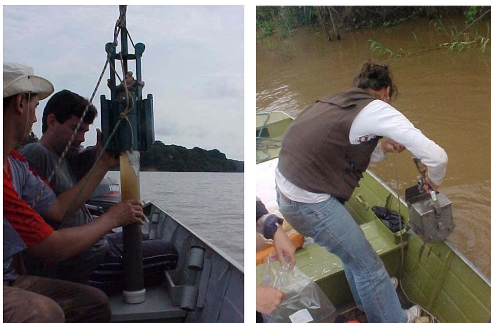
Figura 21. Coleta de sedimento de fundo com perfilador vertical e com draga de *Eckman* nos lagos marginais ao baixo rio Madeira. Fonte: Laboratório de Biogeoquímica Ambiental (2002).
