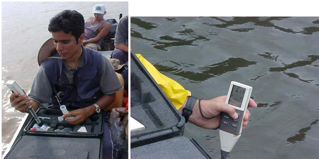
Figura 22. Medição dos parâmetros físico-químicos da água que antecederam as coletas de sólidos em suspensão e sedimento de fundo. *Fonte: Laboratório de Biogeoquímica Ambiental (2002).*
