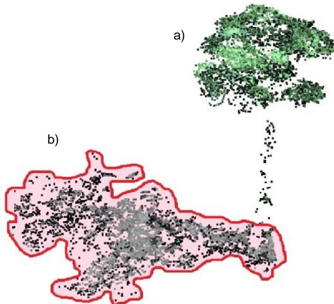
**Figura 2** - Nuvens de pontos do LIDAR: a) árvore de interesse *Hymenaea courbaril* L. var. *stilbocarpa* (Hayne) Lee et Lang (perfilamento pré-exploratório) e b) clareira gerada pelo corte da árvore (perfilamento pós-exploratório) e a demarcação da área de impacto.
