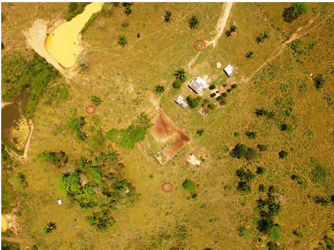
Anexo 1: Pontos utilizados para o refinamento do georreferenciamento das imagens aéreas (destacados em círculos vermelho).
